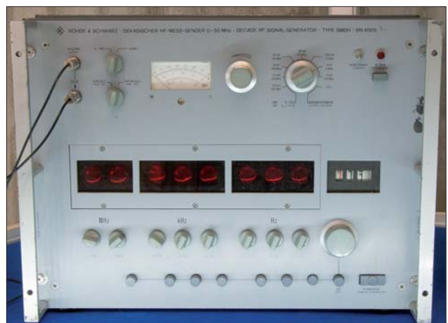
Figura 3 - Applicazione industriale della "Decade di Boella": sintetizzatore di frequenza Rohde & Schwarz (a. 1965)
