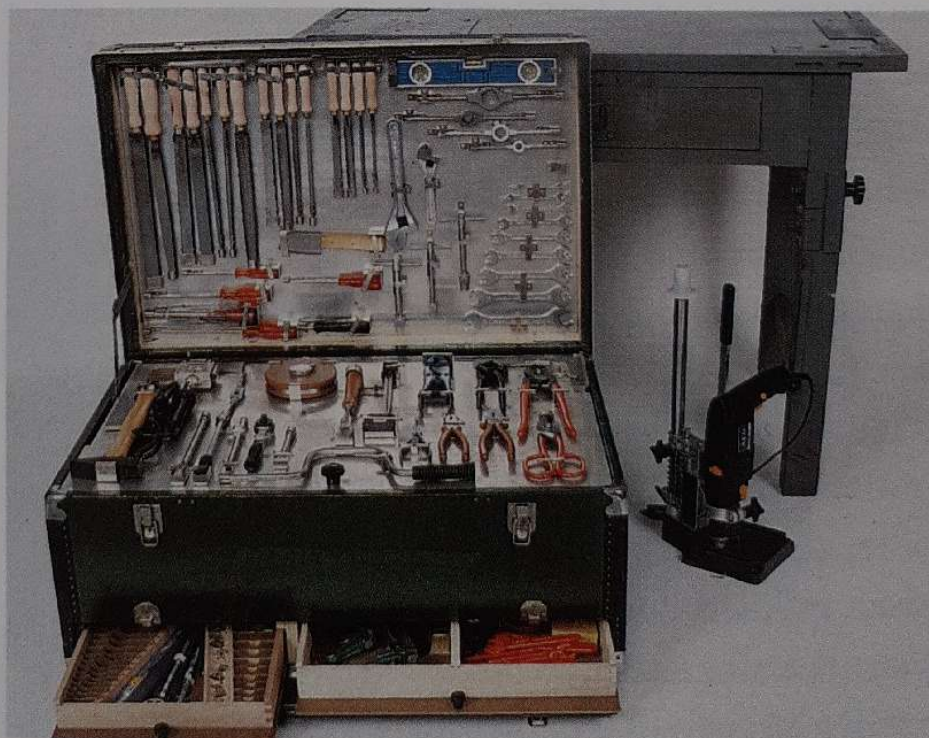
Tipica attrezzatura, per squadra installazione di centrale, costituita da banco da lavoro, cassa attrezzi e trapano da banco
