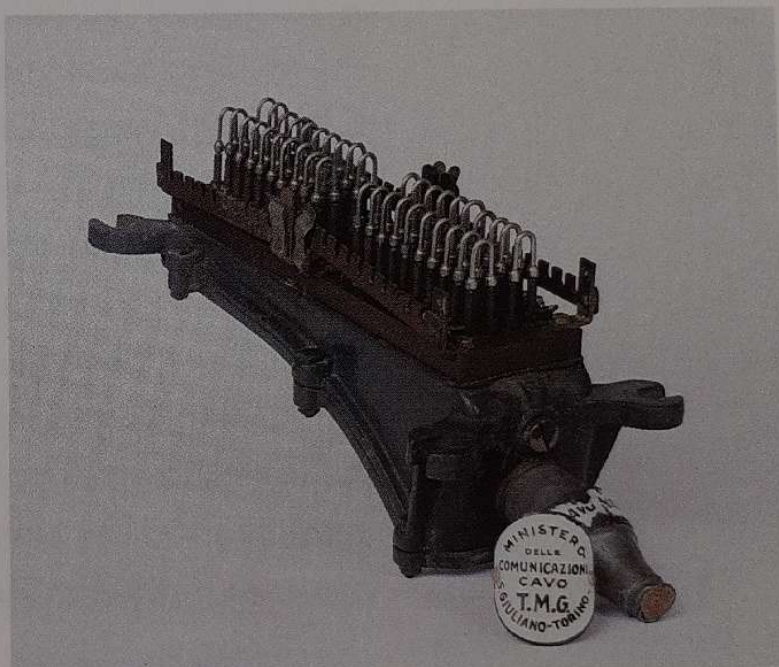
Tipica terminazione del primo cavo amplificato a biccoppie Torino-Milano-Genova (T.M.G.), su cassetta di sezionamento, installata nella centrale di S. Giuliano (1922)
