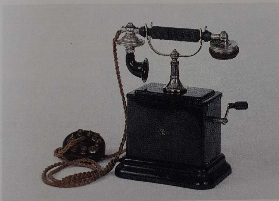
Telefono, da tavolo, a batteria locale con chiamata a generatore, Ericsson (1920)
