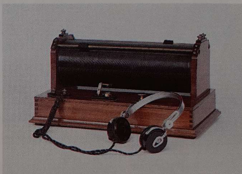
In alto Modello didattico di radioricevitore marconiano, con rivelatore a coherer a limatura metallica, come da esperimenti del 1896, sempre della Campostano (1903)
