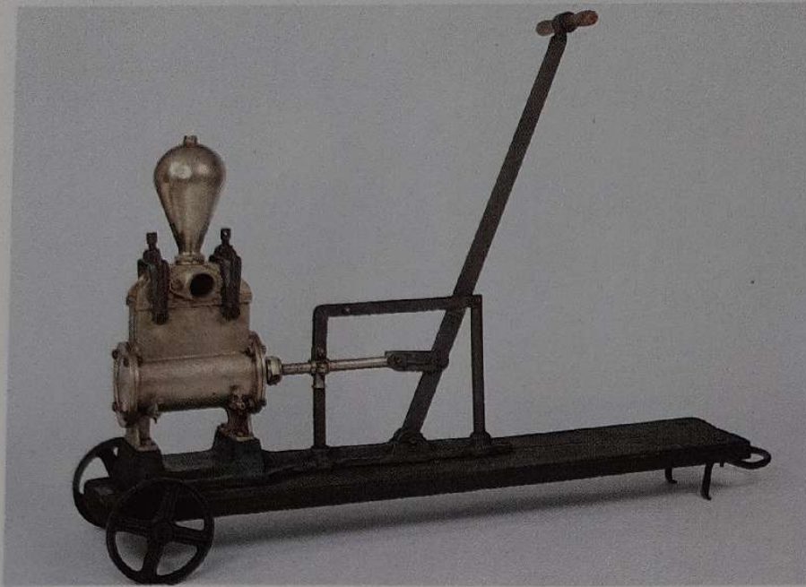
Pompa a mano, aspirante e premente, utilizzata dai gruppi di manutenzione per l'estrazione dell'acqua dalle camerette inondate (1930)
