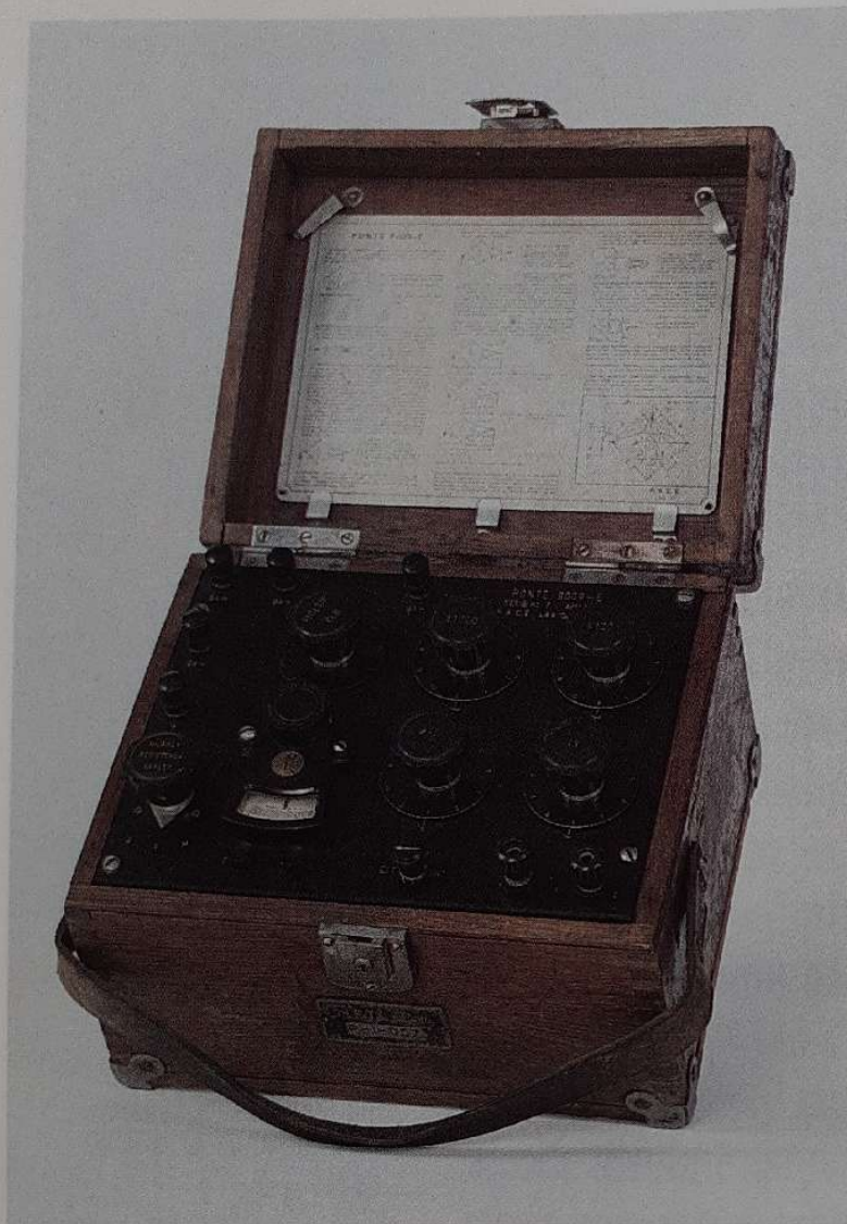
Ponte di Wheatstone per misure di localizzazione guasti secondo i sistemi Varley o Murray Face(1937)
