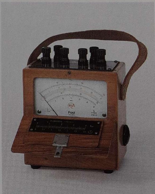
Voltamperometro a bobina mobile di precisione con scala a specchio. Portate fino a 300 V e 0,45 mA. Siemens & Halske (1950)
