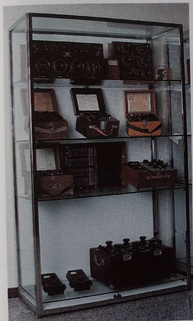
Vetrina contenente ponti di misura di varie epoche e modelli a partire dal 1925 con un ponte di Wheatstone della Siemens & Halske , per misure di resistenza e localizzazione guasti fino ai più recenti, in cassetta di legno di tipo portatile, utilizzati sugli impianti negli anni 1940
