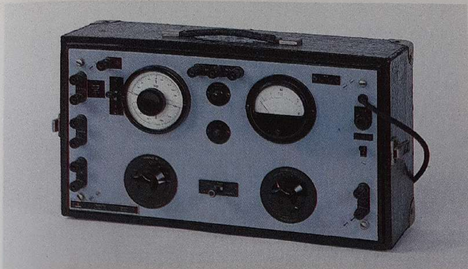
Nella pagina precedente al centro Generatore di segnale a 1.000 Hz Western Electric (1920). In quegli anni i generatori a valvola non avevano ancora soppiantato del tutto i generatori meccanici Nella pagina precedente in basso Valigia per misure di trasmissione (tipo Messkoffer) della Siemens & Halske nella versione del 1930
