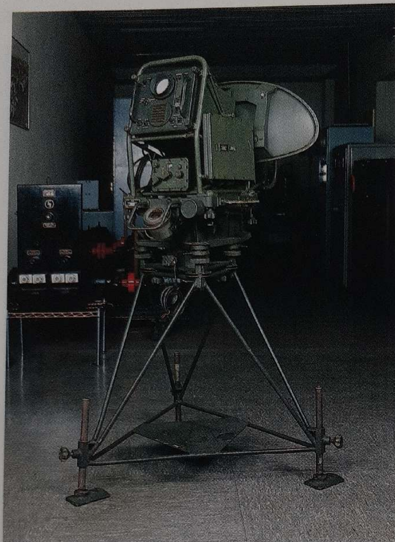
Complesso per misure del campo elettromagnetico per allineamento di antenne di tratte in ponte radio, Signal Corps-USA (1950)
