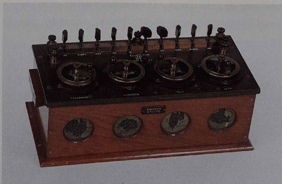
Ponte di Wheatstone di grande precisione da laboratorio Elliot (1940)
