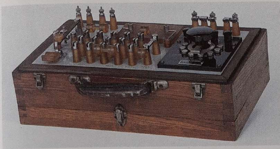
Vetrina contenente ponti di misura di varie epoche e modelli a partire dal 1925 con un ponte di Wheatstone della Siemens & Halske , per misure di resistenza e localizzazione guasti fino ai più recenti, in cassetta di legno di tipo portatile, utilizzati sugli impianti negli anni 1940
